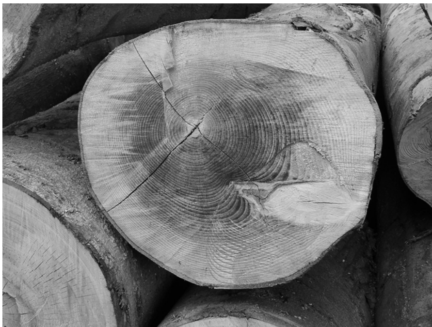
Obr. 8.47 Znak zaparenia na čele bukového výrezu
