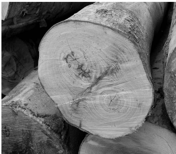
Obr. 8.34 Dvojitý stržeň so zárastom v strede čela ( Fagus sylvatica )
