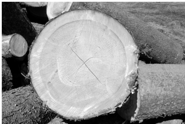
Obr. 8.7 Čelná stržňová trhlina ( Picea abies )
