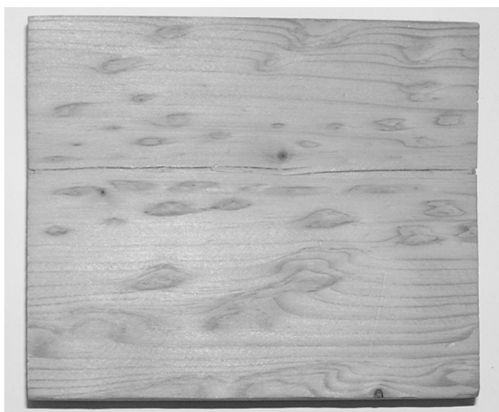
Obr. 2.6 Lieskovcové drevo smreka, tangenciálny rez ( Picea abies )
