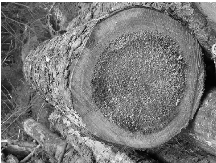
Obr. 8.40 Hniloba stredovej časti ( Picea abies )
