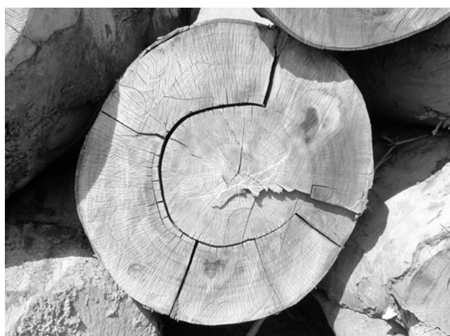
Obr. 8.8 Čelná odlúpavá trhlina ( Fagus sylvatica )
