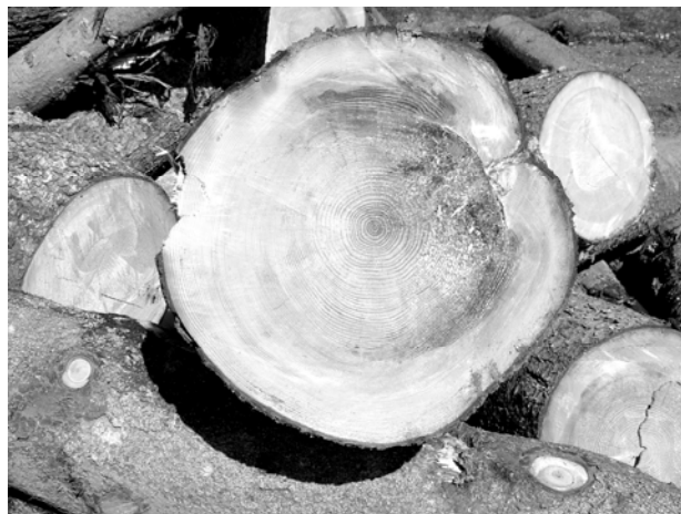
Obr. 8.42 Zásušok na povrchu kmeňa, priečnom reze je bránou pre začínajúcu hnilobu
