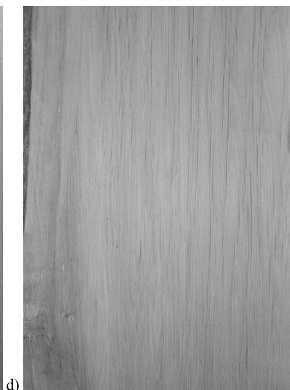
Obr. 1.11 Stržňové lúče a) Schematické zobrazenie, b) priečný rez duba, c) radiálny rez čerešne, d) tangenciálny rez hrabu.
