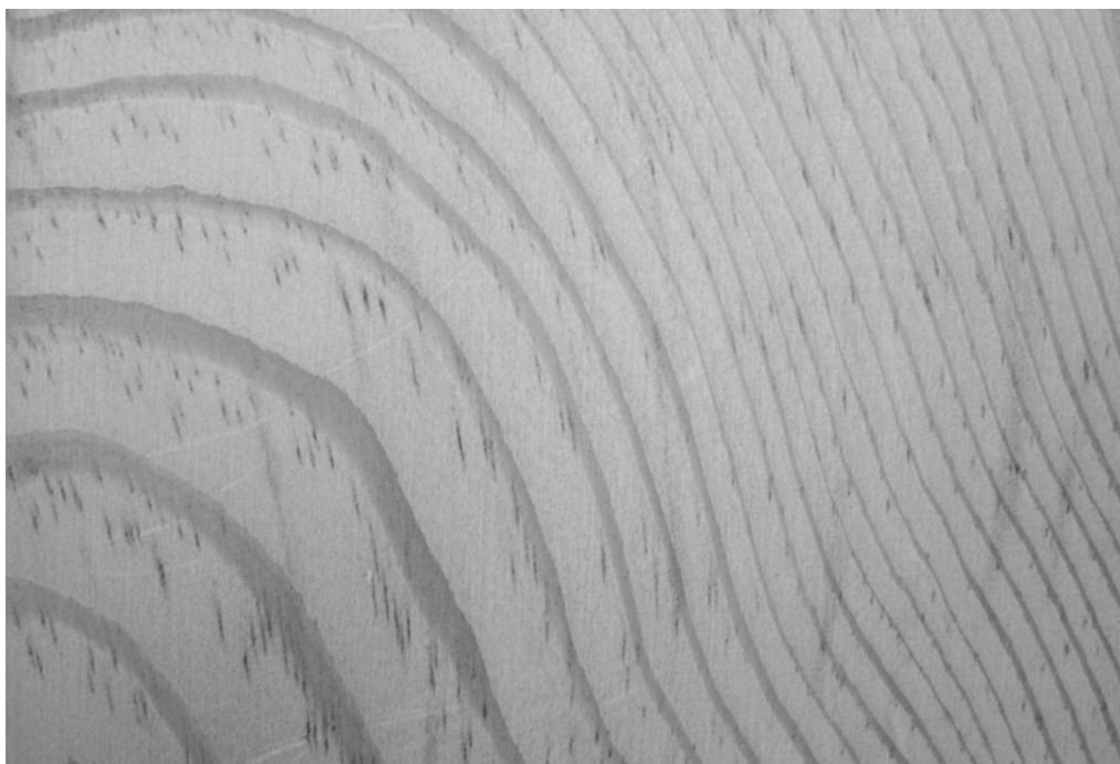
Obr. 1.12 Živicové kanáliky na tangenciálnom reze borovice
