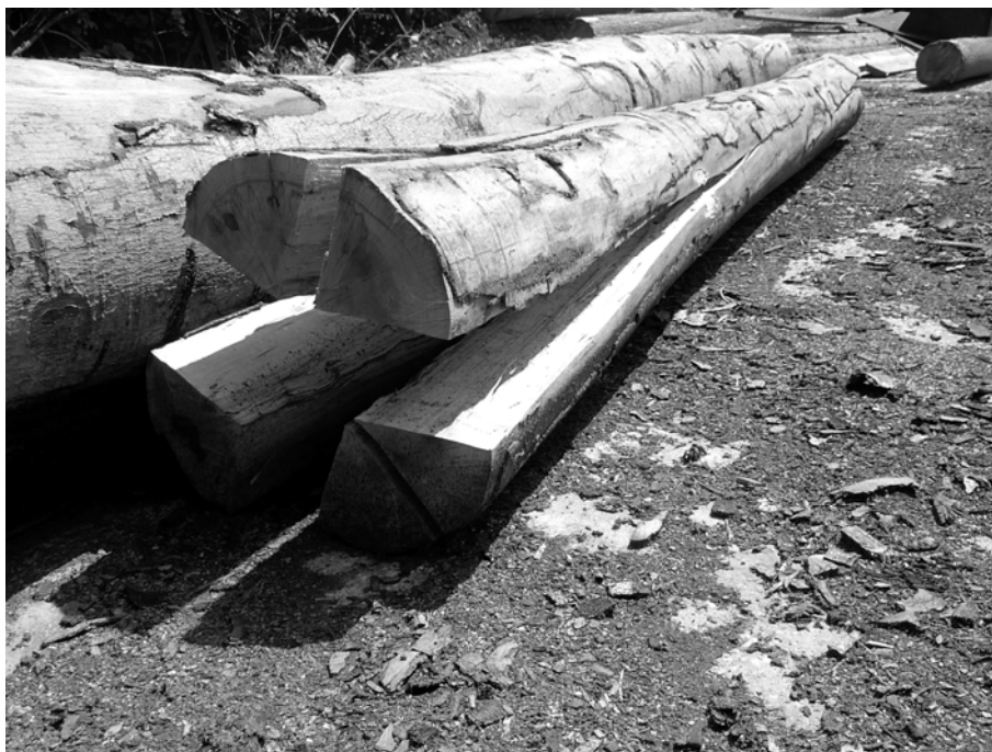
Obr. 8.20 Trhliny vytvorené uvoľnením rastových napätí v reakčnom dreve ( Fagus sylvatica )
