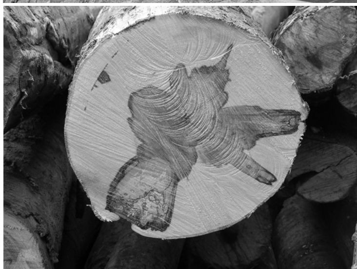
Obr. 8.45 Nepravé jadrá hviezdicovitý (a), okrúhle (b) a plamencový (c)
