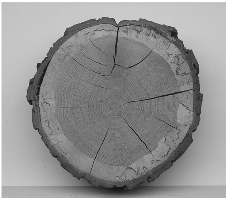
Obr. 8.39 Beľová hniloba na dube ( Quercus petraea )
