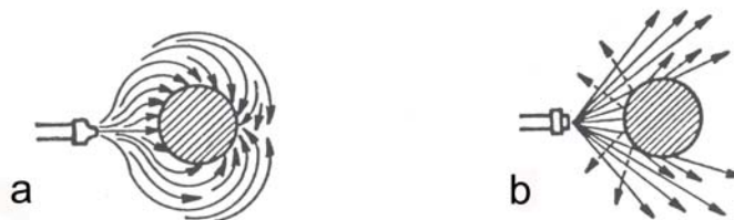
Obr.88 Priebeh pohybu rozptýlených čiastočiek náterovej látky pri striekaní a) v elektrostatickom poli b) v prirodzenej atmosfére
